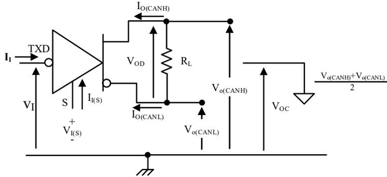
**图 1 驱动器电压、电流测试定义**
