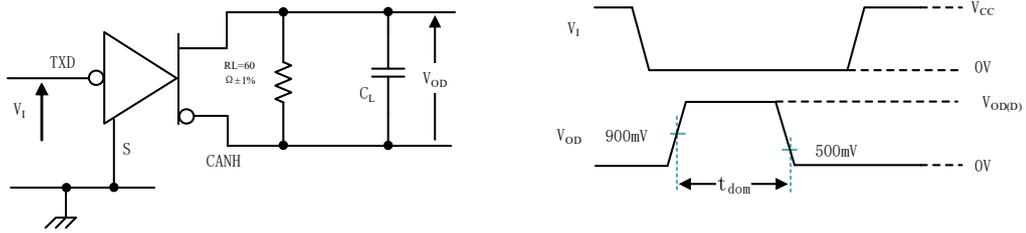
**图 4 显性超时测试电路与波形**
