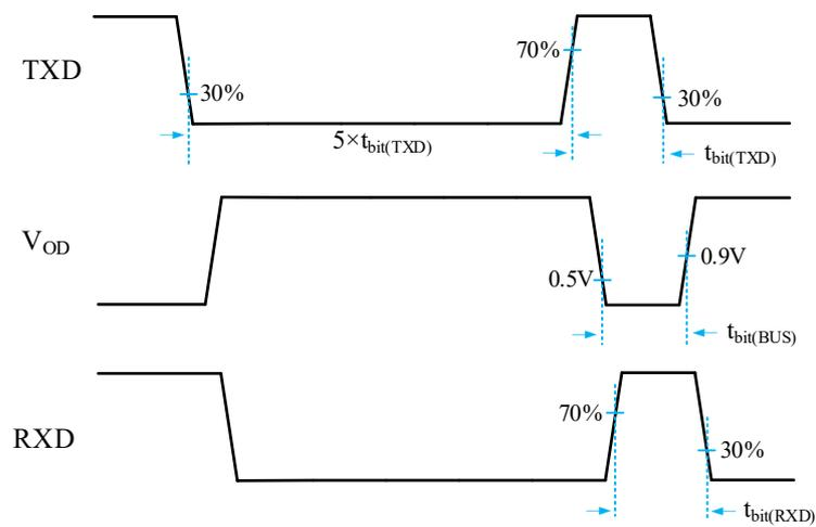
**图 5  $t_{bit}$  测试电路与波形**
